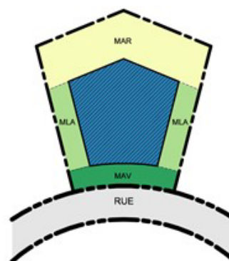
6. Terrain intérieur situé à l'extérieur d'une courbe
